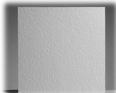
Рис. 1. Входная часть фильтра-картона
