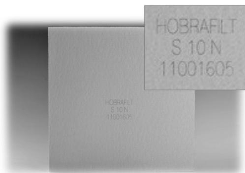
Рис. 2. Выходная часть фильтра-картона
