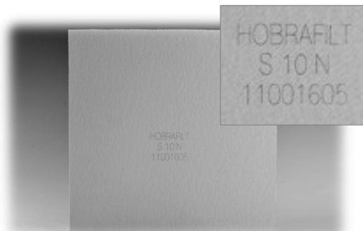
Bild 2. Austrittsseite der Filterschicht
